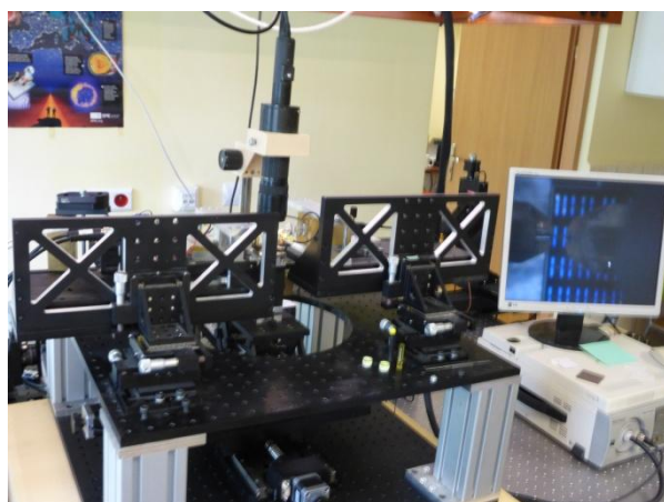
Rysunek 1. Zbudowana przeze mnie stacja do pomiarów ostrzowych (a) oraz wyniki ostrzowego pomiaru czułości struktury tranzystorowej MOSFET zrealizowanego za jej pomocą (b).
